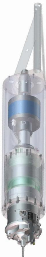
Électrobroche intégrée de 4 KW avec un couple maximum entre 0 et 3000 tr/min et une vitesse maximale de 5000 tr/min générée par un moteur de type broche de machine-outil CN avec aimants «terre rare».
