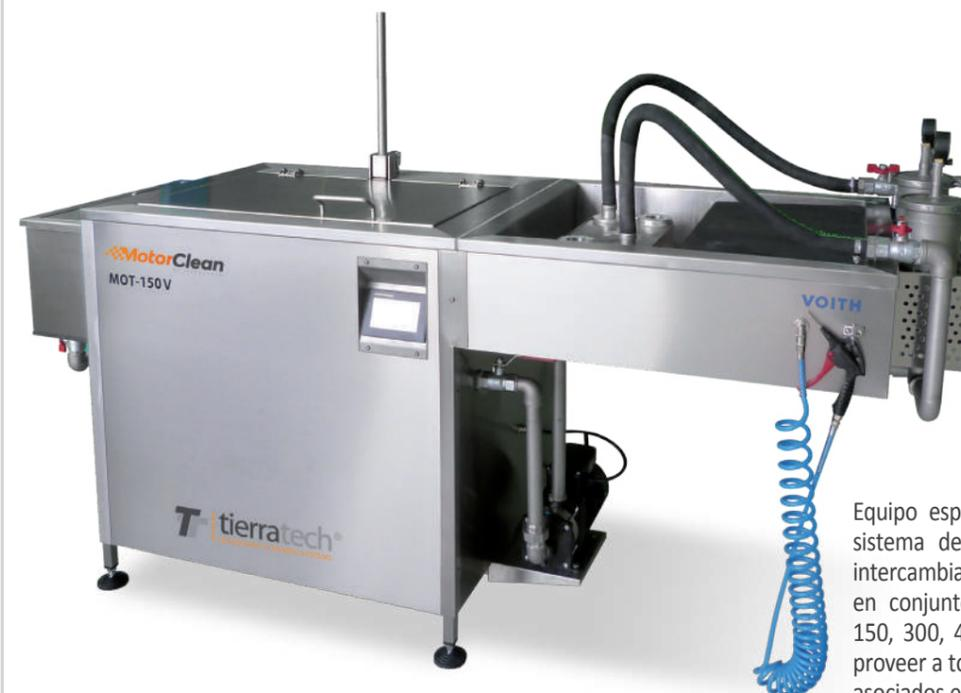
Equipo especial de 150 litros de capacidad y sistema de recirculación y comprobación de intercambiadores de calor. TierraTech® desarrolla en conjunto con **Voith Turbo** 4 modelos de 150, 300, 400 y 600 Litros de capacidad para proveer a todos sus talleres de mantenimiento y asociados en el mundo.
