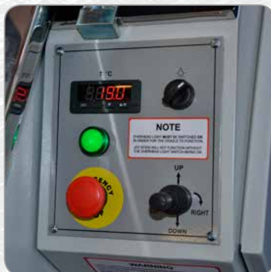
Control panel Pannello di comando
