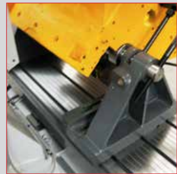
3. AZ601 UNIVERSAL V-ENGINE FIXTURE WITH 45° REFERENCE SQUARE AZ601 Supporto universale motori a V completo di squadra a 45°
