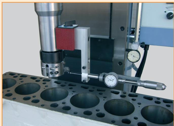
L'alesatrice/spianatrice ACF 200 riunisce le due principali operazioni di ricondizionamento dei monoblocchi di vetture e camion quali alesatura e spianatura in un'unica macchina offrendo prestazioni normalmente ottenibili solo con modelli di fascia superiore: infatti, pur mantenendo dimensioni esterne particolarmente contenute, le caratteristiche tecniche consentono una notevole capacità di lavoro grazie agli ampi spostamenti longitudinale e trasversale della tavola e verticale della testa.
