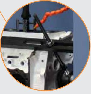
Supporto universale fissaggio cilindri •
