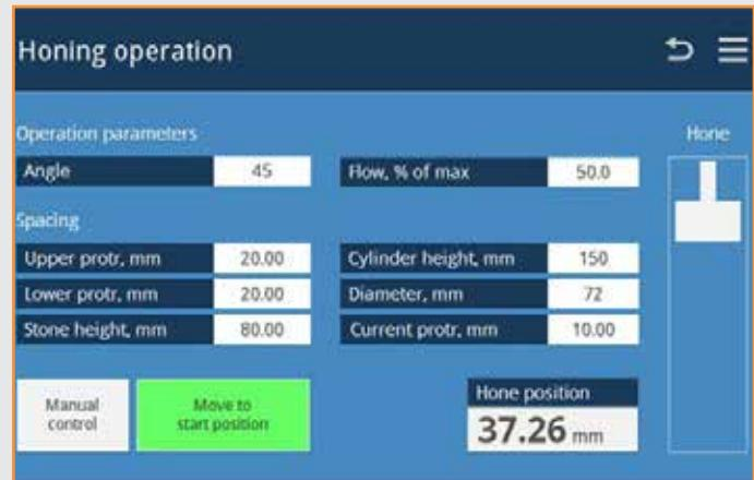
LEV300 è una macchina progettata per levigatura di cilindri di blocchi motore e per tutti gli altri tipi di applicazioni industriali di precisione in cui è richiesta tale operazione.
