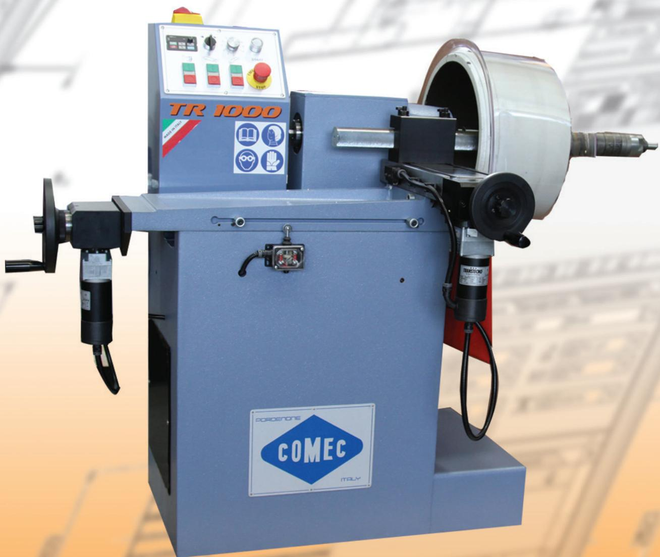
**TORNIO PER TAMBURI E DISCHI FRENO AUTOCARRI E VETTURE**
