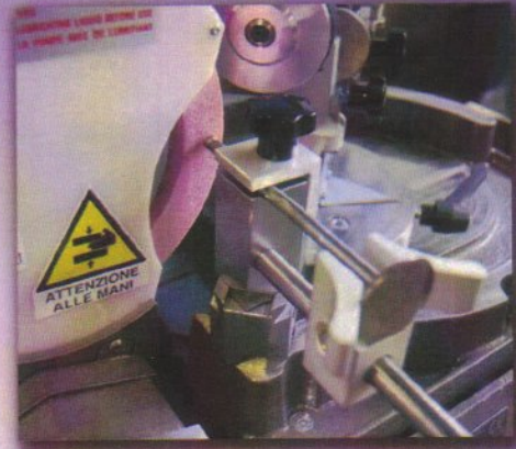
Rettifica del piede valvola Valve end refacing
