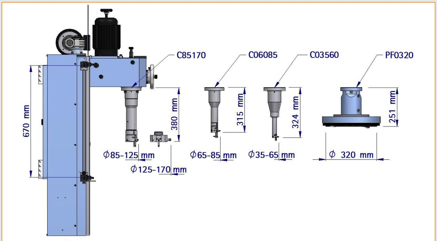
L'alesatrice/spianatrice ACF200.CNC riunisce le due principali operazioni di ricondizionamento dei monoblocchi di vetture e camion, quali alesatura e spianatura, in un'unica macchina e da ora in maniera totalmente automatica grazie al controllo CNC.
