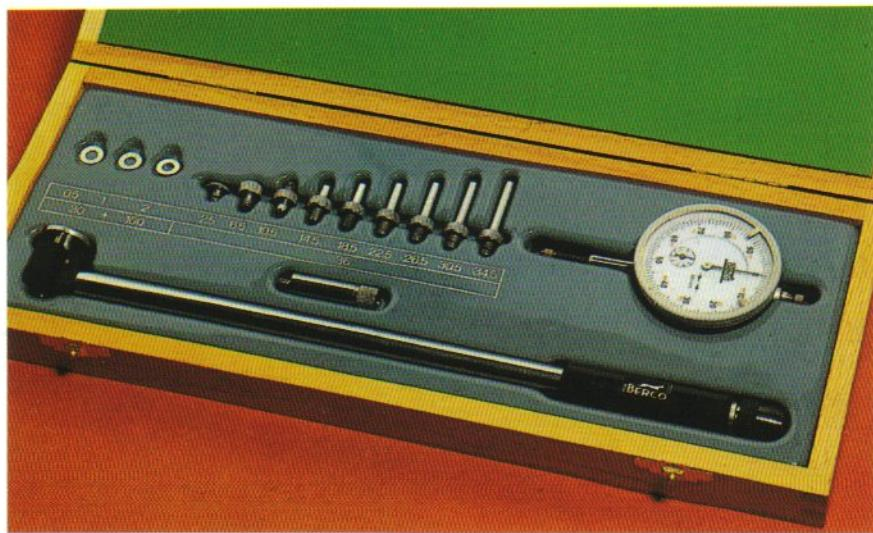
Gli alesametri BERCO sono strumenti di misura che consentono di rilevare in modo semplice e preciso, il diametro, la rotondità e la conicità dei fori.
