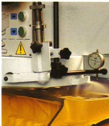
Spianatura di un blocco cilindri con mola a settori abrasivi.
