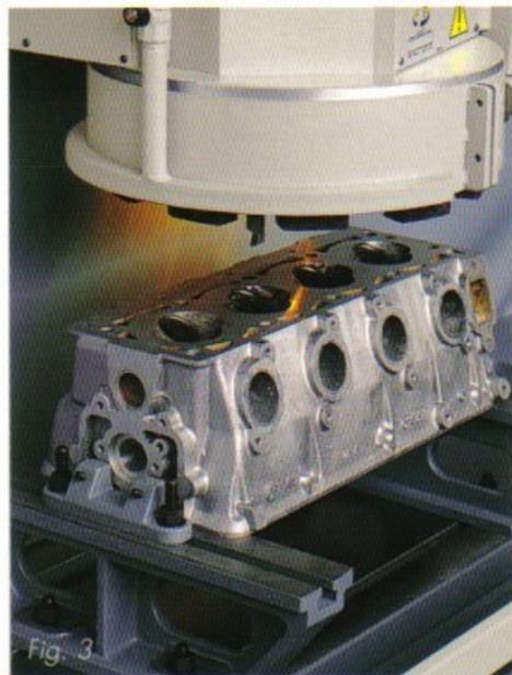
Fig. 3 - Spianatura di una testa mediante utensile. La testata è montata su supporti paralleli.
