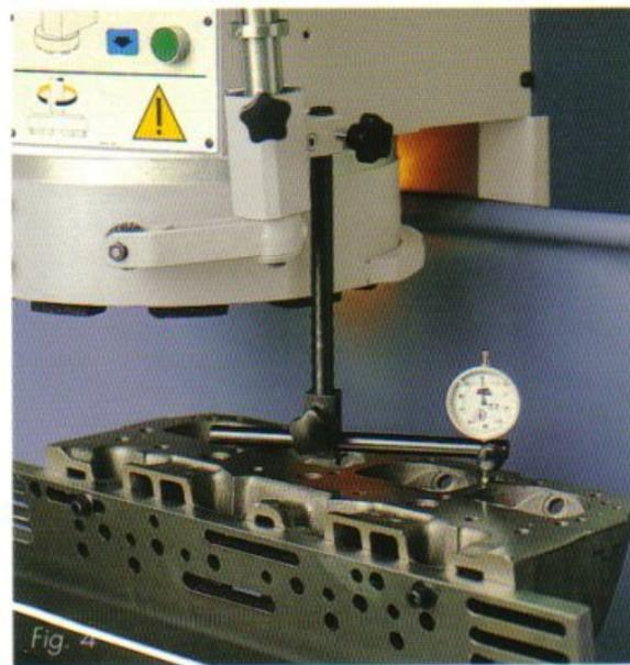
Fig. 4 - Dispositivo per l'allineamento e controllo rettilineità delle superfici.
