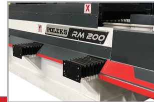
Kızak koruma hareketli körük sistemi Linear slide secure covers
